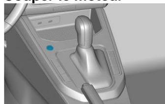
Si le véhicule est équipé du système « Keyless-Entry » : appuyer sur la touche Start/Stop sans actionner la pédale de frein.
