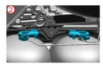
Fermer les soupapes de sécurité (clé plate de 5 mm ou clé polygonale).
