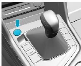
Premere il tasto START/STOP senza azionare il pedale del freno
